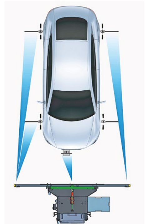
In einem Arbeitsschritt können Radar, aber auch Frontkamera neu justiert werden, wenn das Target einmal geometrisch korrekt ausgerichtet ist. Foto: Bosch
