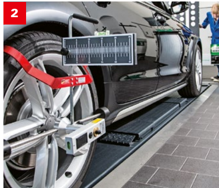
1 Auch bei Nutzfahrzeugen ist die statische Kalibrierung der FAS-Sensorik aufwändig. Der Arbeitsumfang aber grundsätzlich identisch zum Personenwagen. 2 Die Ausrichtung der Targets auf die geometrische Fahrachse kann auch mittels preisgünstigen Lenkgeometrieadaptoren erfolgen. 3 Für die Kalibration von Umfeldkammersystemen bedarf es des Auslegens von Zielteppichen rund ums Fahrzeug, die genau ausgemessen werden müssen. 4 Für Frontkamera-Kalibration eignen sich aufgemalte Ziele, die der Kamera helfen, ihre Optik mittels Software auf die Gegebenheiten zu justieren. Der Nachteil: Für beinahe jede Marke gibt es eigene Targets. Eleganter und zeitsparender ist es, die Targets entweder mit einem grossen Fernseher/Screen einzublenden oder wie im Bild mit einer Beamerwand die verschiedenen Ziele einzublenden. Fotos: Bosch (2), Hella Gutmann, Würth.
