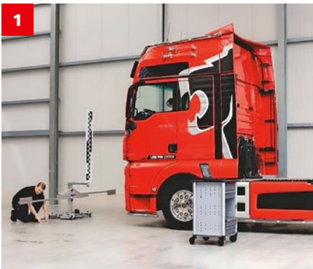
1 Auch bei Nutzfahrzeugen ist die statische Kalibrierung der FAS-Sensorik aufwändig. Der Arbeitsumfang aber grundsätzlich identisch zum Personenwagen. 2 Die Ausrichtung der Targets auf die geometrische Fahrachse kann auch mittels preisgünstigen Lenkgeometrieadaptoren erfolgen. 3 Für die Kalibration von Umfeldkammersystemen bedarf es des Auslegens von Zielteppichen rund ums Fahrzeug, die genau ausgemessen werden müssen. 4 Für Frontkamera-Kalibration eignen sich aufgemalte Ziele, die der Kamera helfen, ihre Optik mittels Software auf die Gegebenheiten zu justieren. Der Nachteil: Für beinahe jede Marke gibt es eigene Targets. Eleganter und zeitsparender ist es, die Targets entweder mit einem grossen Fernseher/Screen einzublenden oder wie im Bild mit einer Beamerwand die verschiedenen Ziele einzublenden. Fotos: Bosch (2), Hella Gutmann, Würth.
