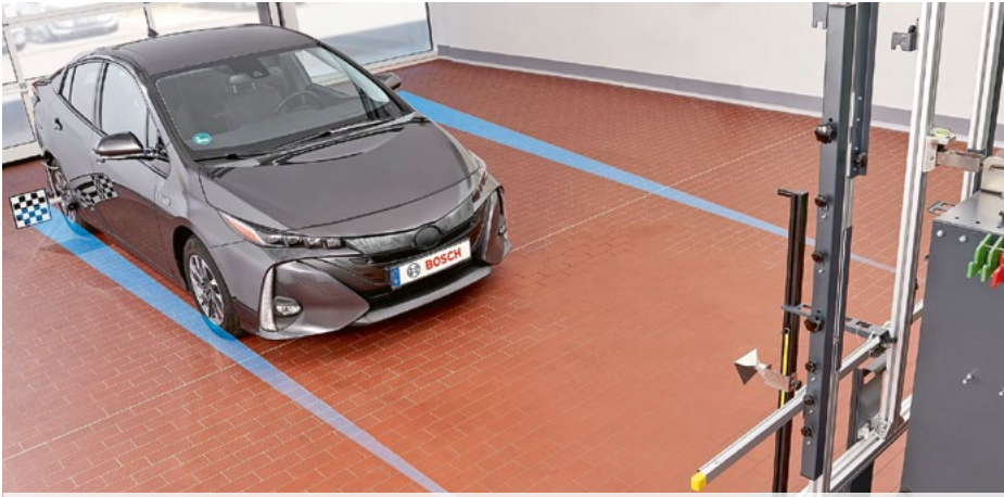
Die statische Kalibration von Radarsensoren erfolgt entweder wie bei vielen Fahrzeugmodellen japanischer oder südkoreanischer Automobilhersteller mittels Radarreflektor oder einfachen Targets. Basis ist immer die präzise Ausrichtung der Messwerkzeuge auf die geometrische Fahrachse, um die Justage herstellerekonform vorzunehmen.
